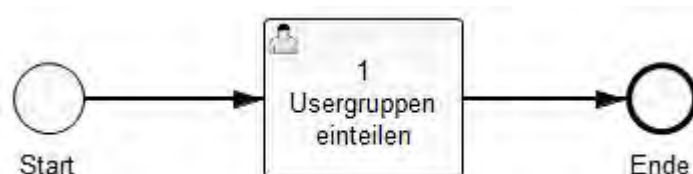
Abb. 23: Prozess mit einer User Task
